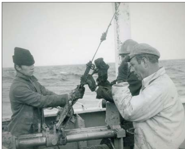
Підготовчі роботи перед спуском ґрунтової трубки в районі Дунайського підводного каньйону. 1989 р.
